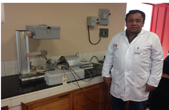
Figura 3.4: Espectrómetro Mössbauer. Se utiliza para la obtención de propiedades químicas, estructurales y magnéticas de un material.
