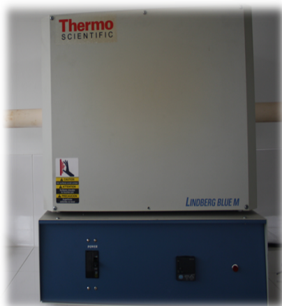
Figura 3.20: Horno con rampas controladas de 1500C. Utilizado para la sintetización de materiales cerámicos.
