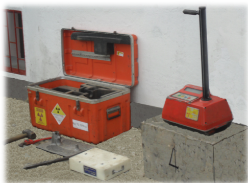
Figura 3.3: Densímetro Nuclear MC-1DR Portable. Utilizado para el control de calidad de pavimentos.
