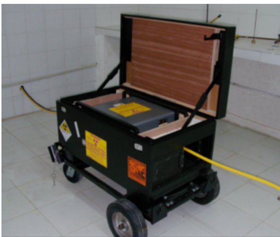
Figura 3.5: Equipo de Gammagrafía Industrial. Utilizado en la determinación experimental de las variaciones de densidad y espesor en distintos materiales.
