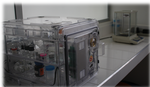
Figura 3.19: Equipo desecador eléctrico. Su función es la de aislar y proteger de cualquier agente externo que pueda dañar las muestras.
