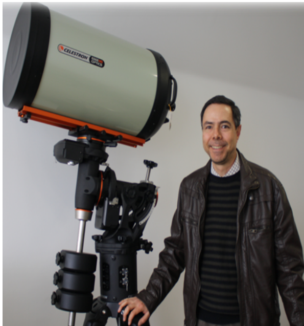
Figura 3.24: Telescopio Celestron CGE PRO 1400. Utilizado para la observación astronómica en el óptico y ultravioleta cercano.
