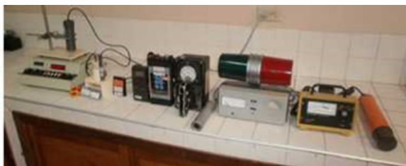
Figura 3.8: Equipo general. Este equipo permite medir la dosis absorbida cuando se trabaja con instrumentos que contienen material ionizante.
