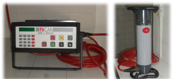
Figura 3.6: Equipo para producción de Rayos-X. Utilizado en el control de calidad de soldaduras de placas fundida y forjada.
