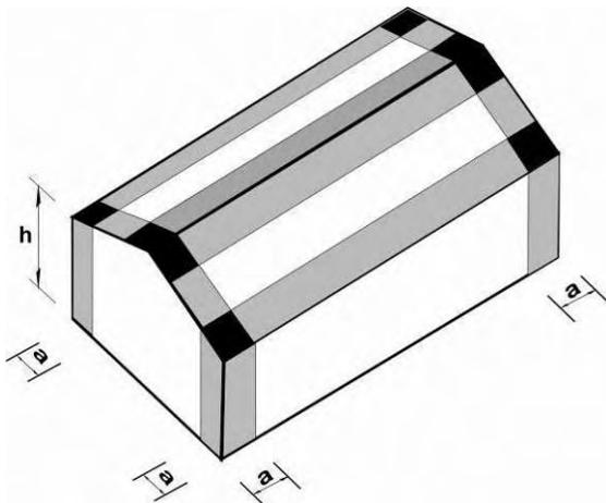
Cubierta a Dos Aguas ( $\theta \leq 7^\circ$ )
